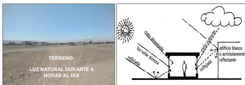
Figura 62. Vista de la Iluminación Natural y criterio a tener en cuenta Fuente: Elaboración Propia
