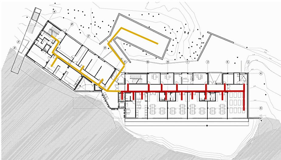
*Figura 21 Circulación de Planta Baja del Proyecto Residencia y Centro de día para discapacitados intelectuales con trastorno de conducta, Barcelona*
