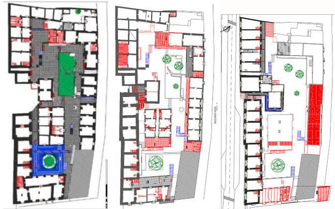
Figura 19 Plano de distribución, indicando con colores el área restaurada, conservada y obra nueva. (negro-conservación)(azul-restauración) (rojo -obra nueva). Fuente: http://moleskinearquitectonico.blogspot.pe
