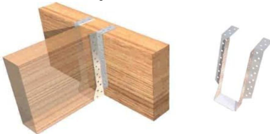
**Figura 42.** Conectores metálicos para fijar elementos verticales como tabiques o pie derecho.
