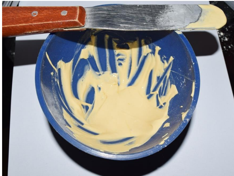
Fig. 9 Mezcla de Polvo y Agua para obtención del yeso en proporción (Según fabricante).
