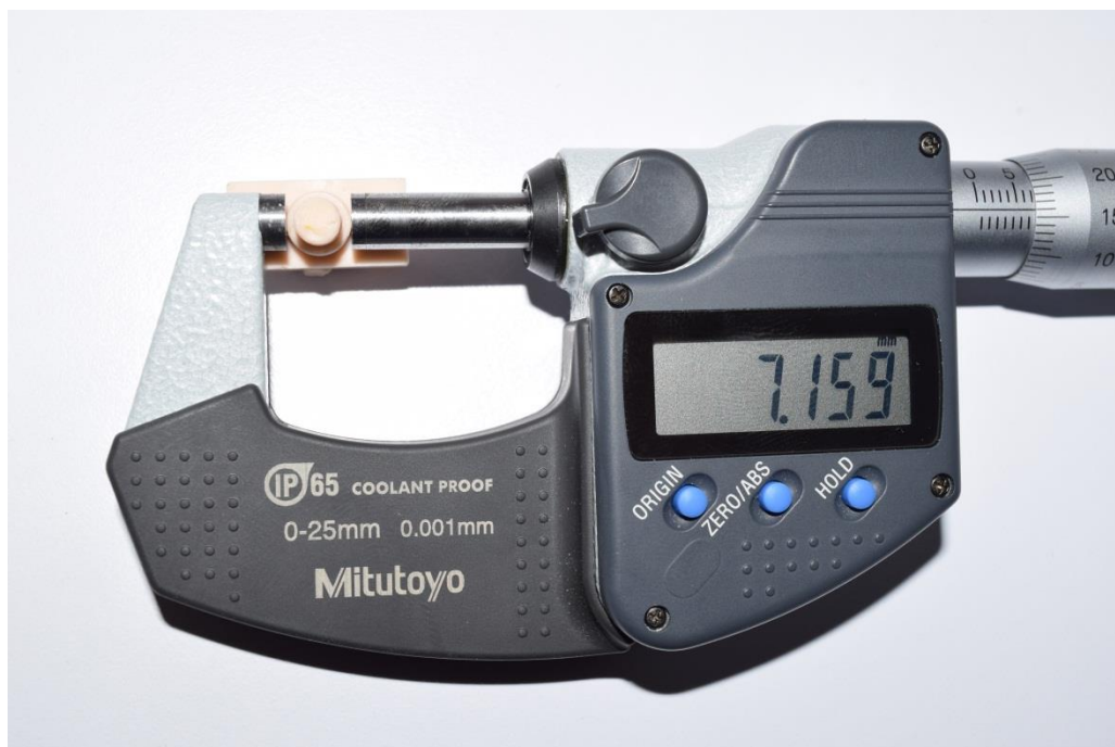
Fig. 11 Medición de la base 2 del modelo definitivo vaciado con silicona para modelos Mach-2®.
