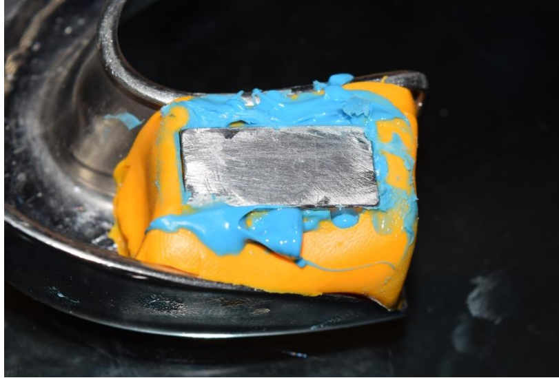
Fig. 5 Segunda impresión del modelo maestro con aplicación de silicona fluida.
