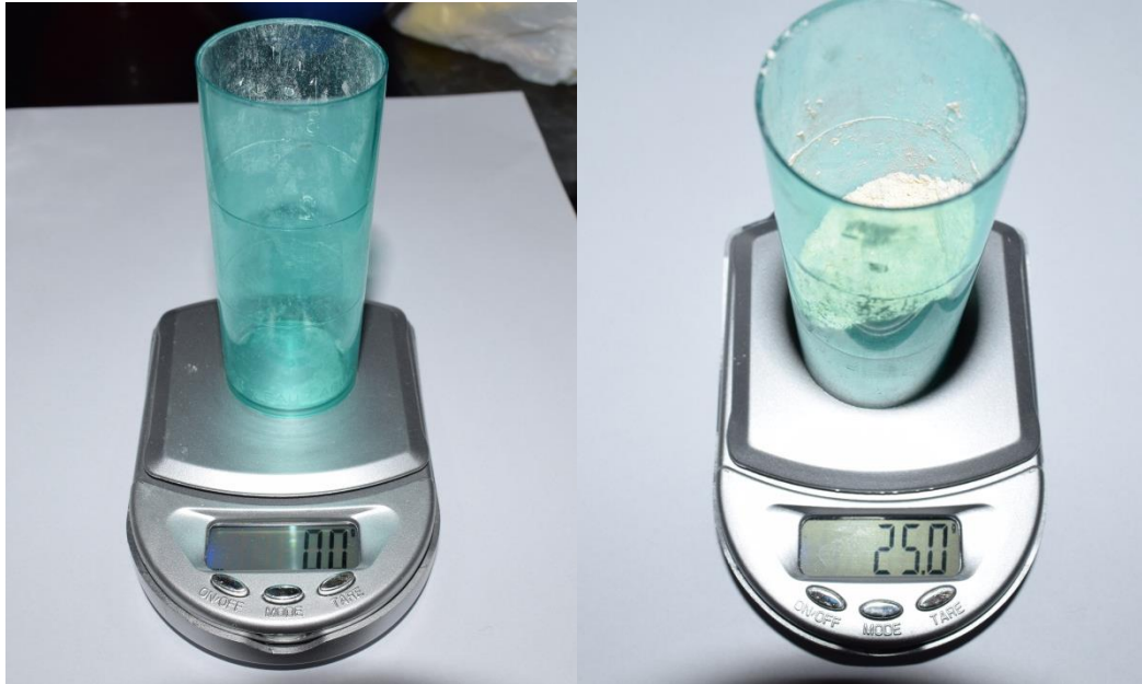
Fig. 7 Calibración de peso en gramos para la proporción de Yeso tipo IV GC FUJIROCK® EP. (Según fabricante)
