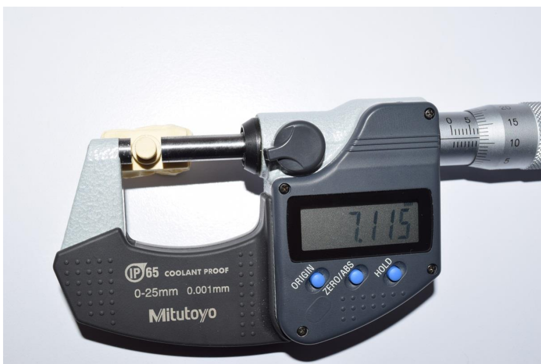
Fig. 12 Medición de la base 2 del modelo definitivo vaciado con Yeso tipo IV GC FUJIROCK®.
